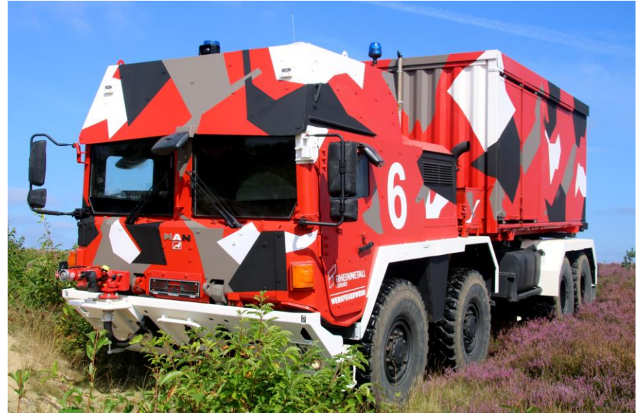
Spezialfahrzeug der Werkfeuerwehr Rheinmetall Unterlüß mit besonderem ballistischen Schutz
