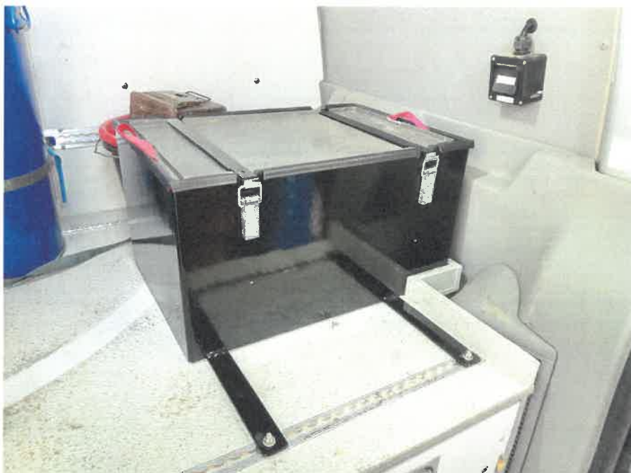
Abb. 18: Schutzrahmen aus hochwertigem Stahl für die Transportkiste Foto: KBD
